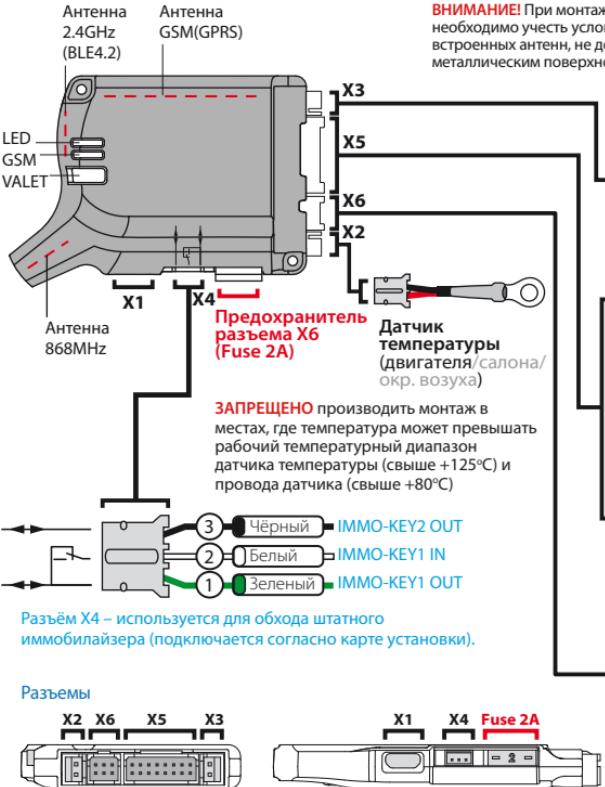
**ВНИМАНИЕ!** Перед монтажом системы: ознакомьтесь с информацией по подключению к автомобилю размещённой на сайте loader.alarmtrade.ru, в программах Pandora Спец и Pandora Alarm Studio; обновите основное ПО и ПО Bluetooth-модема; при подключении цифровых шин CAN/LIN/IMMO-KEY выберите модель автомобиля, тип подогревателя, метод обхода иммобилайзера.
